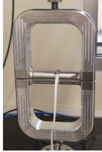
Resim 1. Ortholox® UHMWPE Bant Sisteminin düzenek üzerine monte edilmesi ve monte edilmiş hali
