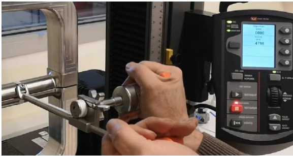
Resim 2. Ortholox® UHMWPE Bant Sisteminin T-Tork cihazı ile sıkıldığı andaki düzeneğe uygulanan Yük Ölçümü
