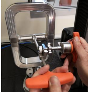
Resim 1. Ortholox® UHMWPE Bant Sisteminin düzenek üzerine monte edilmesi ve monte edilmiş hali
